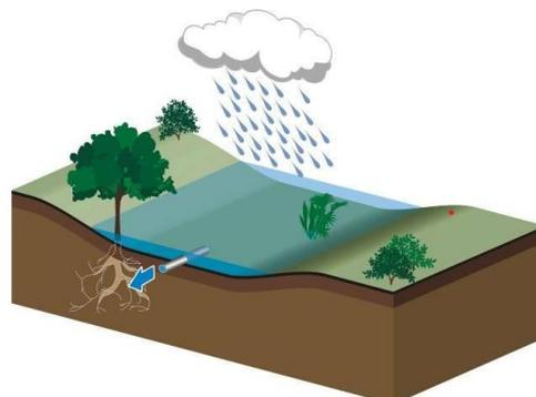
Noue à évacuation superficielle. Le sol est très peu perméable. Les eaux stockées sont évacuées à débit régulier vers un exutoire via un orifice au pied de la noue. Cet orifice doit être très régulièrement entretenu pour éviter toute obstruction (Source : Architecture & Climat)
