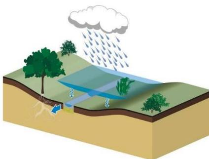
Noue infiltrante (Source : Architecture & Climat)
