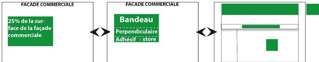
Schéma de principe de répartition des surfaces des enseignes en façade, dans le cas d'une façade commerciale de moins de 50m<sup>2</sup>.
