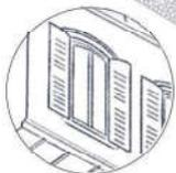
**Fenêtres :** Encadrements plâtre lissés ou à joints creux pour imitation pierre de taille. Garde-corps en fer forgé et volets bois persiennés.
