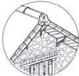
**Toitures :** Débord importants à pannes apparentes, tuiles plates ou mécaniques. Pente de toit de 40° à 45° parfois à pan coupé.
