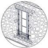
**Fenêtres :** Linteau et/ou encadrement à motif de brique. Garde-corps en fer forgé et volets métal persiennes repliés.
