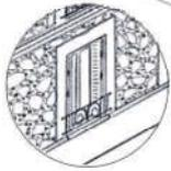
**Fenêtres :** encadrement plâtre lissés ou à joints creux pour imitation pierre de taille. Garde-corps en fer forgé et volets métal persiennes repliés.
