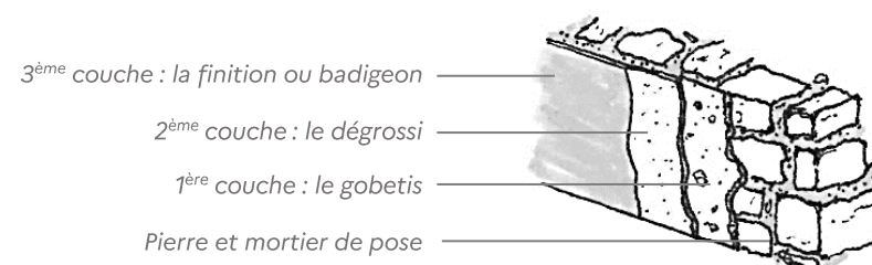
Coupe sur un mur de pierre avec son enduit à la chaux ©UDAP 77
